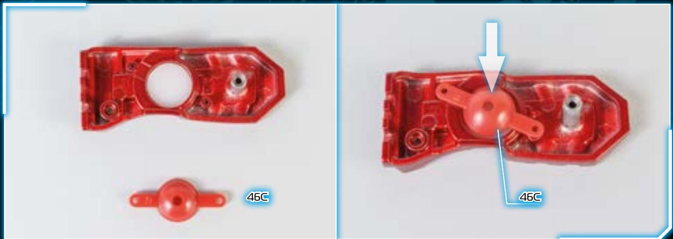
2 - Деталь (46C) — это корпус светодиода, который располагается поверх экрана (46B), установленного вами в предыдущем шаге. Закрепите корпус двумя винтами АМ.
